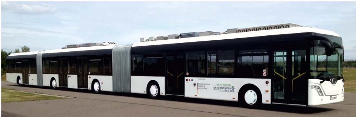
Das dreigliedrige gummbereifte Fahrzeug - entwickelt und gebaut innerhalb des vom Bundesministerium für Bildung und Forschung (BMBF) initiierten Forschungsprogramms »Innovative Regionale Wachstumskerne« - ist mehr als 30 Meter lang und kann bis zu 256 Passagiere befördern.
